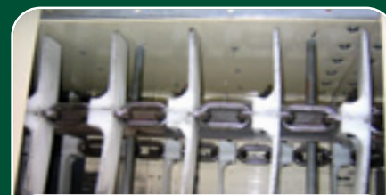
Système Bolt 'n' Go avec des maillons de chaîne en fil Application dans un convoyeur
