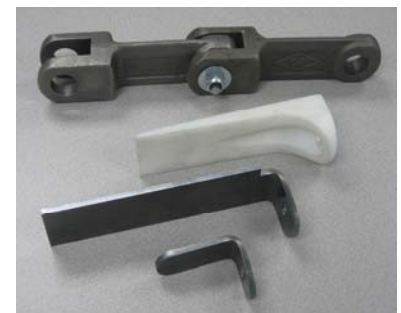
Assemblage de palettes sur chaîne forgée
