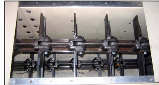
Système Bolt 'N' Go avec de la chaîne forgée Application dans un Convoyeur
